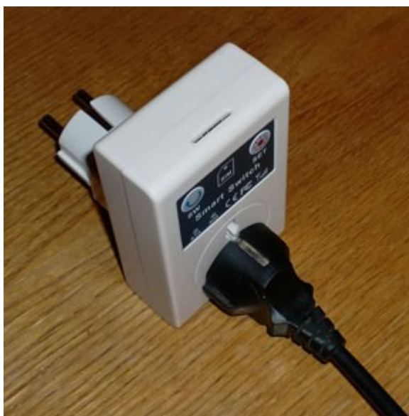
Рисунок 1. Модуль дистанционного sms управления
